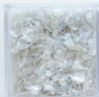
Le bottiglie dopo essere state raccolte, selezionate e sottoposte a processi di lavaggio e tritazione, vengono trasformate in scaglie.
